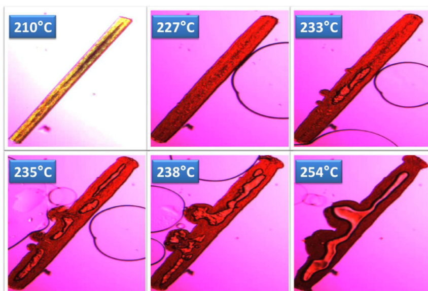
Figura 15 - Imagens de microscopia óptica de um fio de cabelo quando aquecido em silicone.
